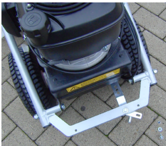
Illustration 5 : Orientation de la languette d'enclenchement
