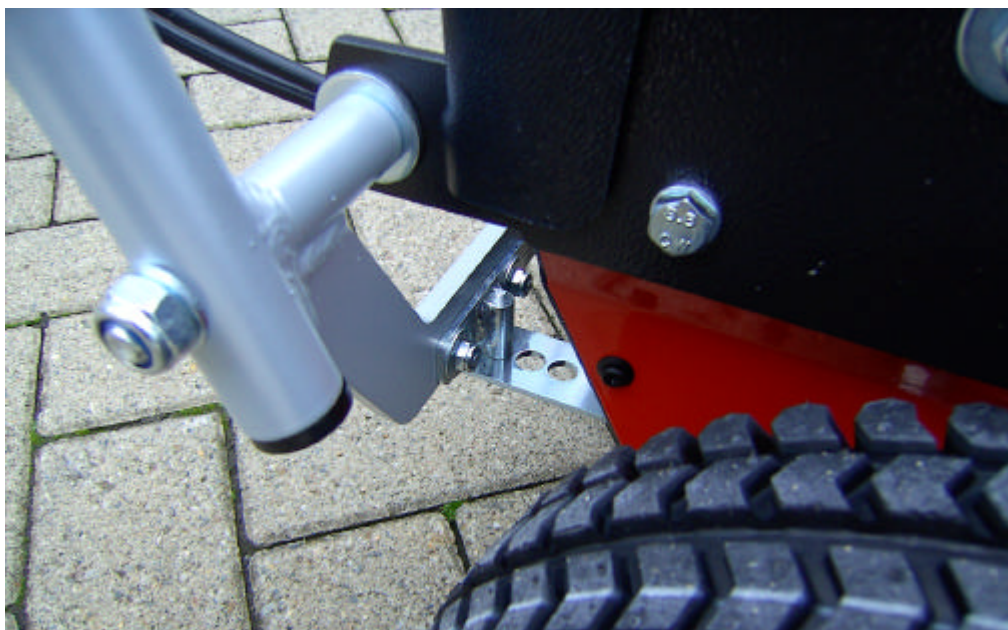
Illustration 6 : Montage correct de la languette
