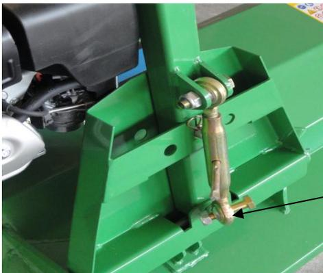
3. Una volta che la trincitrice è a livello piano del suolo, serrare il dado di bloccaggio (A).
