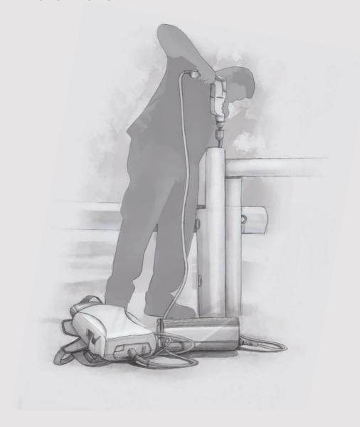
« Le Power Convertor transforme le courant continu de la batterie en courant alternatif 230 V / 1000W max. »
