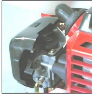
**Tourner droite la vis de réglage “T” du carburateur pour un mélange plus pauvre
