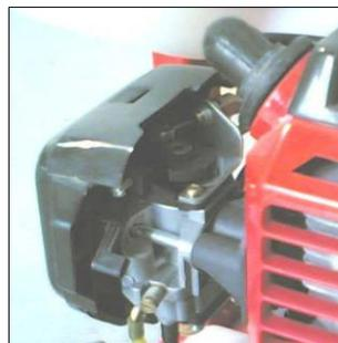
Appuyer sur le bouton de commande d'inondation jusqu'à ce que le carburant s'écoule du carburateur
