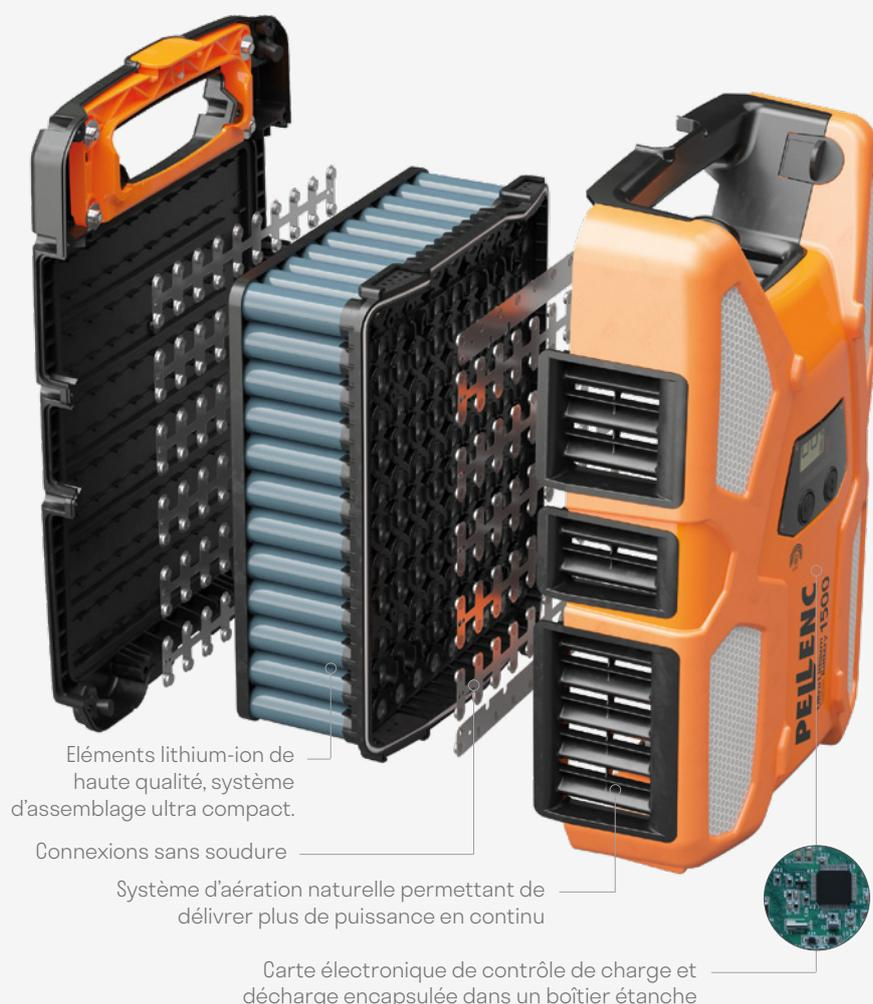
Eléments lithium-ion de haute qualité, système d'assemblage ultra compact.
